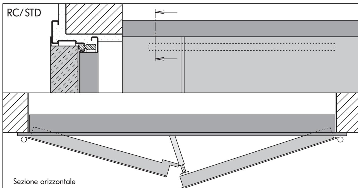
Regolatore di chiusura **RC/STD** con ammortizzatore d'urto incorporato per porta a due ante. Inserito nel canale di battuta del traverso superiore del telaio.
