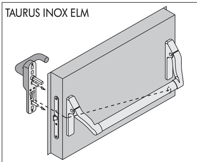
L'elettromaniglia viene fornita non montata.
