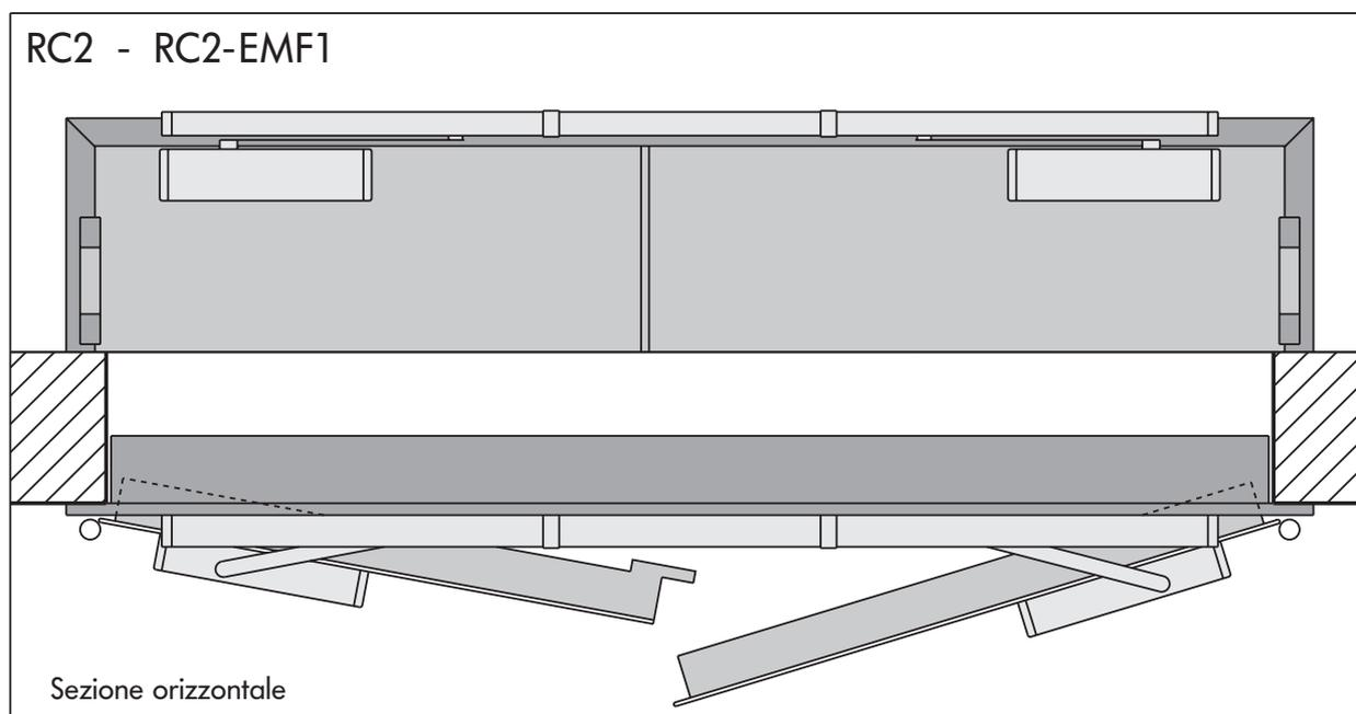
Sistema di chiusura **RC2**, composto di 2 chiudiporta CP2 e regolatore per la sequenza di chiusura integrato nella guida di scorrimento. Larghezza foro muro minimo 1200 mm. Colore argento. Forza EN 4.
