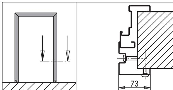
Imbotte **IM (4)** assiemabile a 90°, di rivestimento del muro in acciaio zincato dello spessore di 15/10 mm. Verniciatura con polveri epossipoliestere termoindurite, con finitura a struttura antigraffio gofrata, colore pastello turchese tonalità scura (NCS5020-B50G), oppure RAL su richiesta. Fornitura su richiesta e comprendente viti di fissaggio (escluso fori). Si consiglia la combinazione con guarnizione di battuta FF.
