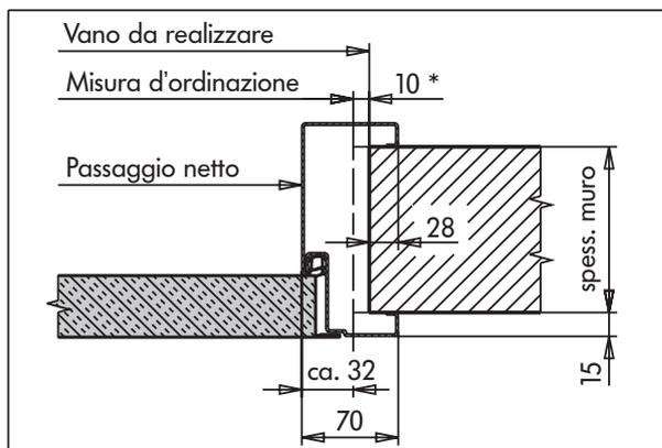
Cassaporta abbracciante **SPEED** per porta Rever assemblabile in cantiere, in lamiera zincata dello spessore di 1,25 mm, da stringere su parete finita con 6 morsetti integrati e 2 distanziali da tassellare o avvitare, compresa la guarnizione di battuta e la verniciatura RAL. Profilo 55/70
