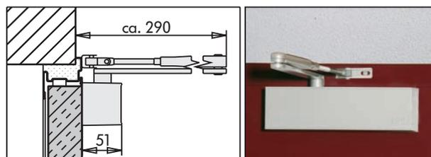
**Chiudiporta** aereo a cremagliera, **CP1** con braccio a compasso, regolazione della velocità di chiusura e del colpo finale. Colore argento.
