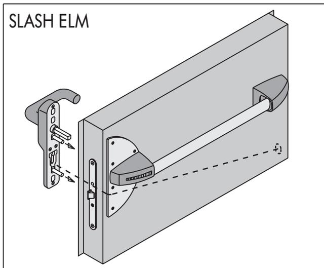
**Elettromaniglia multitemensione** per sistema di "apertura controllata" realizzata con corpo in metallo e maniglia in alluminio verniciati colore nero.
