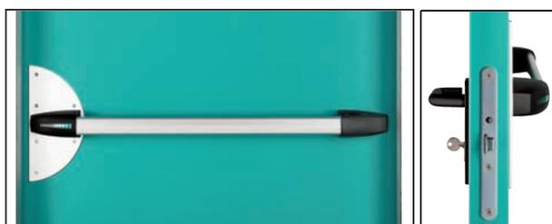
Maniglioni antipanico **SLASH** comandi in acciaio con protezioni in materiale plastico colore nero, barra e placca coprifori in alluminio anodizzato naturale - ingombro 75 mm. Tipologie BM - BSP - BS - BMC e BC applicabili su porte ad una anta oppure su ante principali, tipologia A per ante secondarie. Disponibile anche come Kit per successiva applicazione in cantiere.
