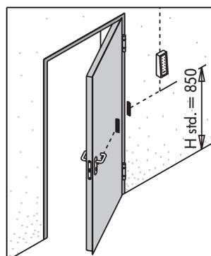
La porta fornita con il sistema di **CONTROLLO ACCESSO SCA** è dotata di serratura (antipanico o normale) con dispositivo incorporato, contatti elettrici tra anta e telaio e cablaggio tra serratura e contatto elettrico dell'anta. Il funzionamento viene descritto più dettagliatamente sulle pagine "controllo accesso SCA" nel capitolo PROGET.
