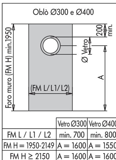
Su richiesta nelle porte multiuso ad una e due ante possono essere inseriti **oblò rettangolari** completi di cornici di contenimento avvitate e vetro. Le dimensioni possono essere del tipo standard come sopra illustrato, oppure su misura, rispettando tuttavia le misure dei bordi. Come bordi si intende la distanza dal foro muro della porta fino al vetro inserito nell'oblò.
