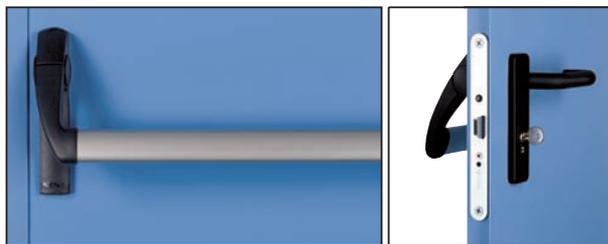
Maniglioni antipanico **TWIST** comandi in acciaio con protezioni in materiale plastico colore nero e barra in alluminio anodizzato naturale - ingombro 100 mm. Tipologie BM - BSP - BS - BMC e BC applicabili su porte ad una anta oppure su ante principali, tipologia A per ante secondarie. Disponibile anche come Kit per successiva applicazione in cantiere.
