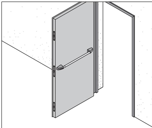
**Serratura a tre punti** di chiusura laterali, per porte PROGET multiuso. Combinata con cilindro e maniglia **M1** a leva interna e esterna, oppure nella versione antipanico **BM** con mezzamaniglia esterna, **B** esternamente completamente cieca e maniglione antipanico Twist **TW**, Slash **SL**, Taurus inox **TX** o Touchbar **TB** dal lato interno. Fornibile anche su anta principale di porte a due ante.
