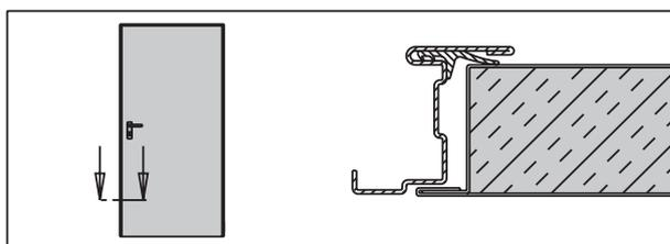
**Guarnizione FF** di battuta in gomma di colore nero da inserire a pressione nell'apposito canale sul telaio. Fornita solo su richiesta in rotoli sfusi da tagliare e montare in cantiere.
