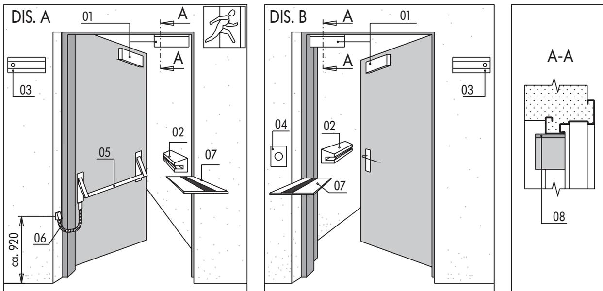
Sistema „Apertura controllata“ con maniglione antipanico (DIS. A) o con maniglia (DIS. B).
