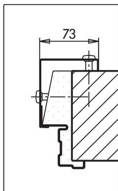
Guarnizione **FF** di battuta in gomma di colore nero da inserire a pressione nell'apposito canale sul telaio. Fornita solo su richiesta e in rotoli sfusi da tagliare e montare in cantiere.
