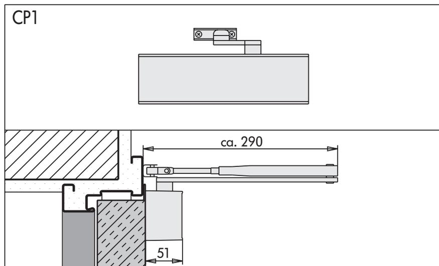
Chiudiporta **CP1** aereo a cremagliera con regolazione della velocità di chiusura e dell'urto di chiusura. Colore argento. Forza variabile da 3 fino 4.
