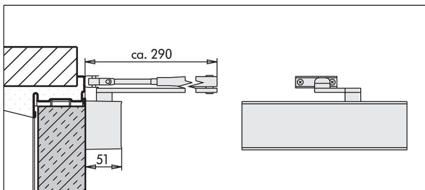
Chiudiporta **CP1** aereo a cremagliera con regolazione laterale della velocità di chiusura e dell'urto di chiusura. Colore argento. Forza variabile da 3 fino 4.
