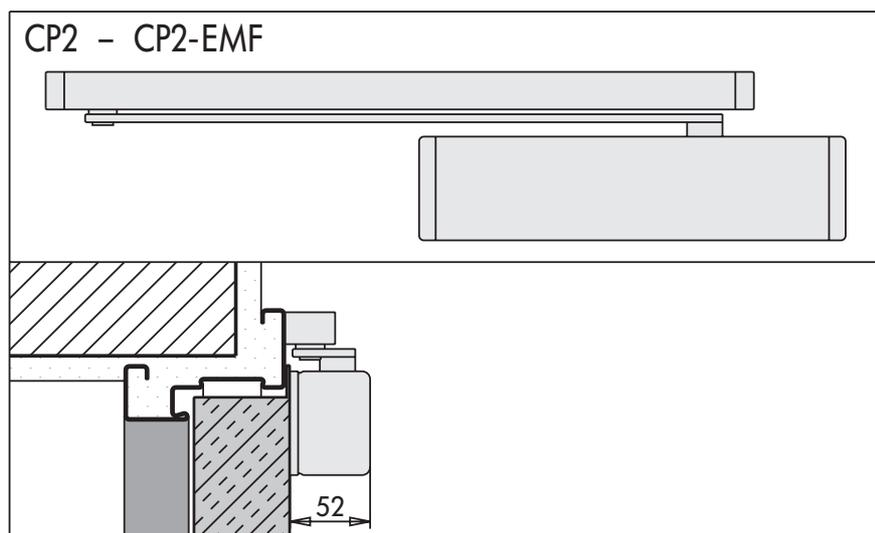
Chiudiporta **CP2** aereo a cremagliera con guida di scorrimento e regolazione della velocità di chiusura. Colore argento. Forza EN 4.
