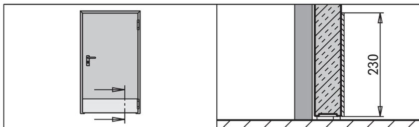
Zoccoli in lamiera inossidabile satinata **INOX** dello spessore di 10/10 mm da fissare con nastro biadesivo sull'anta in basso. Fornitura su richiesta per porte ad una e due ante (indicare il lato di applicazione).
