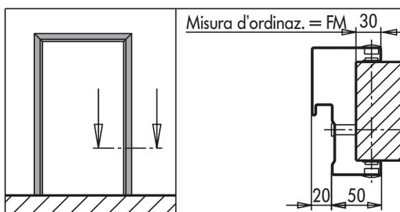
Telaio adatto al montaggio in luce per porte Multiuso PROGET ad una e due ante in lamiera d'acciaio zincato spessore 15/10 mm con giunti per l'assemblaggio in cantiere, staffe di rinforzo, fori di fissaggio e tappi di copertura.
