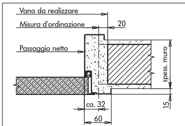
Cassaporta abbracciante **SOLID** per porta Rever assemblabile in cantiere, in lamiera zincata dello spessore di 1,25 mm, da murare con zanche o dotata di cavallotti da tassellare o avvitare, compreso distanziale inferiore asportabile, guarnizione di battuta e la verniciatura RAL. Profilo 45/45
