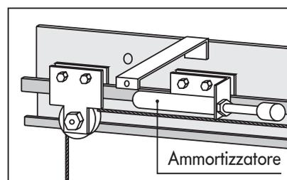
L'anta del portone dotata di **fusibile termico** nello stato normale non è condizionata dal contrappeso. L'ammortizzatore finecorsa assorbe il colpo finale in chiusura.
