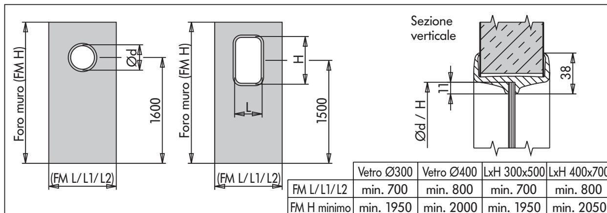
**Oblò** per porte PROGET multiuso ad una e due ante realizzato con profilo perimetrale in gomma EPDM colore nero e vetro stratificato 3 + 3 mm trasparente.
