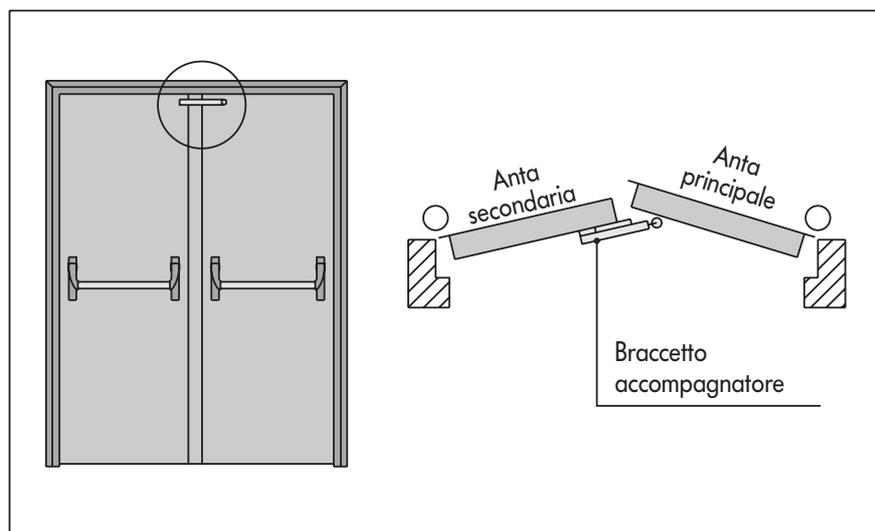
Porte tagliafuoco predisposte per l'applicazione della maniglia M14 oppure per i maniglioni Twist o Slash tipo A vengono fornite con **braccetto accompagnatore** (non montato) per consentire l'intervento del regolatore di chiusura spingendo solo l'anta secondaria.
