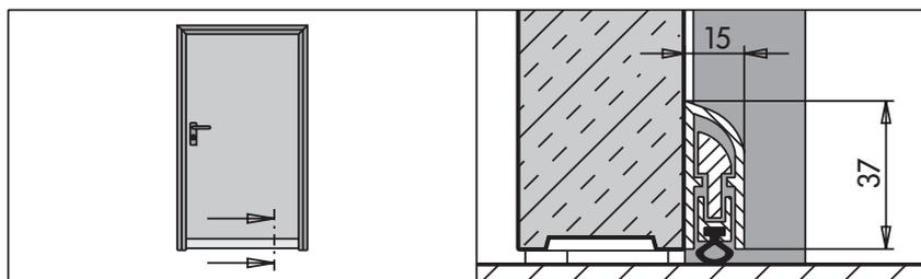
**Guarnizione sottoporta** automatica da avvitare esternamente all'anta dal lato opposto alle cerniere, per un migliore fonoisolamento.
