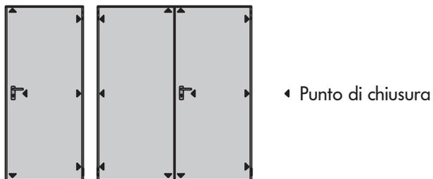
Versione porta **REVER SECUR** ad una anta ed a due ante con serratura a tre punti di chiusura compreso cilindro europeo. Disponibile anche come KIT per l'applicazione in cantiere. Le porte Rever Secur mantengono la caratteristica di reversibilità.
