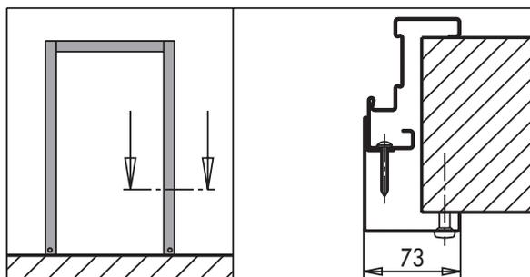
**Telaio abbracciante** in acciaio zincato dello spessore 15/10 mm, per porte PROGET multiuso ad una e due ante. Fornitura in 3 parti con giunzioni angoli a 45° da avvitare, finitura con vernici a polveri, imballo in nylon. Spessore e tipo di muro da indicare all'ordine (da 100 a 400 mm). Sistema di fissaggio da definire in fase di ordinazione.
