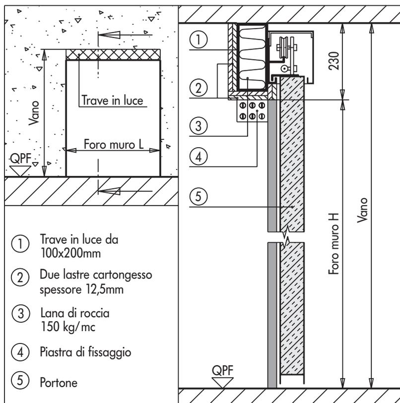
La **trave in luce isolata** da 100 x 200 mm è omologata per portoni scorrevoli REI 120 ad una e due ante. La trave viene fornita con la predisposizione per il fissaggio laterale. Oltre L = 2500 viene anche predisposto un fissaggio a soffitto. Il rivestimento della trave con due lastre di cartongesso da 12,5 mm è a carico del cliente.
