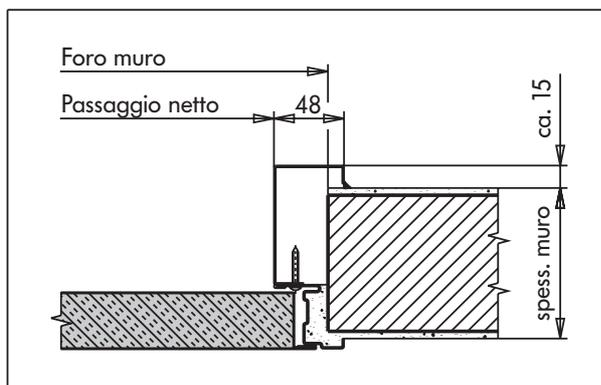
**Imbotte** assemblabile di rivestimento del muro per porte Rever, realizzato in lamiera zincata d'acciaio dello spess. di 12/10 mm. Giunzioni angoli da avvitare. Verniciatura con polveri epossipoliestere termindurite. Imballo compreso. Fornitura su richiesta e non comprendente viti e fori.
