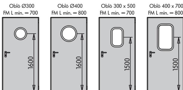
**Oblò** per porte REVER ad una e due ante realizzato con profilo perimetrale in gomma EPDM colore nero e vetro stratificato 3 + 3 trasparente. Indicare il senso di apertura della porta.
