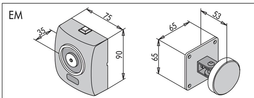
Elettromagnete **EMP** da pavimento composto da nucleo in ferro zincato con pulsante per sblocco e zoccolo di fissaggio. Ancora composta da piattello in ferro nichelato e zoccolo snodato.
