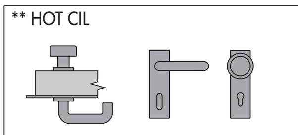
Di serie le porte sono dotate di maniglie tipo **M1** in materiale plastico colore nero e anima in acciaio. Su richiesta possono essere fornite anche le tipologie illustrate. Le maniglie fanno parte degli accessori e vengono fornite non montate. **Le maniglie M1 e M2, possono essere fornite anche in acciaio inossidabile con finitura satinata e placca arrofondata. I modelli M2, M4, M5, M9 e HOT CIL non sono combinabili con serratura a tre punti.**
