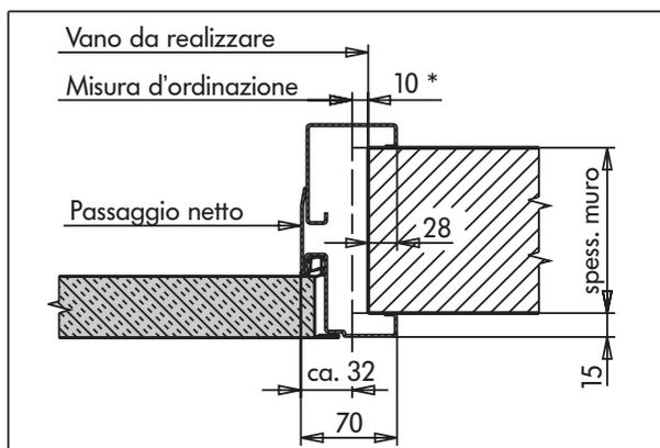
Cassaporta abbracciante telescopica **TESCOP** per porta Rever a due parti, in lamiera zincata dello spessore di 1,25 mm, da avvitare su parete finita, compreso distanziale inferiore asportabile, guarnizione di battuta e la verniciatura RAL. Profilo 55/70
