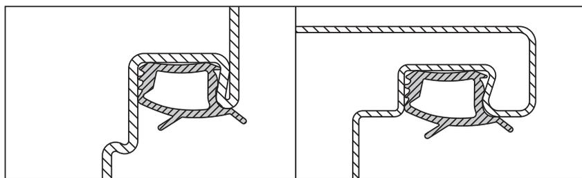
Guarnizione **FF** di battuta in gomma di colore nero da inserire a pressione nell'apposito canale sul telaio e sul montante centrale di controbattuta dell'anta secondaria nel caso di porta a due ante. Fornita solo su richiesta e in rotoli sfusi da tagliare e montare in cantiere.
