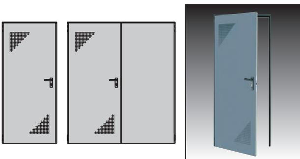
**Fori d'aerazione** per porte REVER ad una anta ed per ante principali di porte a due ante; realizzati con punzonatura delle lamiere nella configurazione illustrata, passaggio aria ca. 200 cm<sup>2</sup>. Le porte Rever con fori d'aerazione mantengono la caratteristica di reversibilità.
